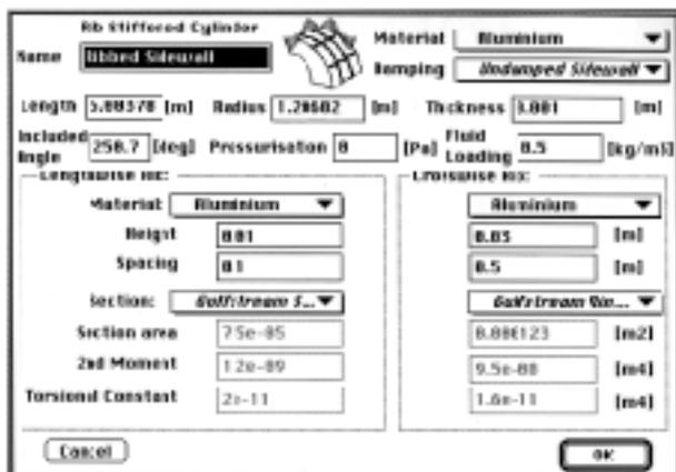
Figure 2 : Paramètres descriptifs d'un élément de fuselage dans une modélisation SEA d'un aéronef dans le logiciel AutoSEA.
