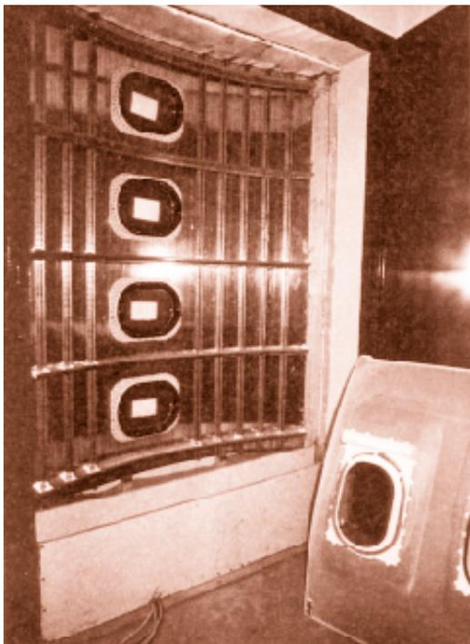
Figure 8 : Structure de fuselage d'avion montée en laboratoire acoustique pour mesure de transmission.
