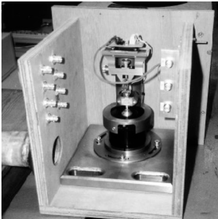
Fig.4 : Vue du prototype de G.A.C qui a été développé. On peut y apercevoir la vanne dont la surface de passage est modulée en amplitude grâce au vibreur électrodynamique. L'ensemble du dispositif est placé dans une boîte hermétique (de volume égal à quelques dm³), qui joue le rôle de chambre de compression. Cette chambre est alimentée via une bonbonne d'air sec comprimé. Le tuyau d'alimentation est visible en bas à gauche.
