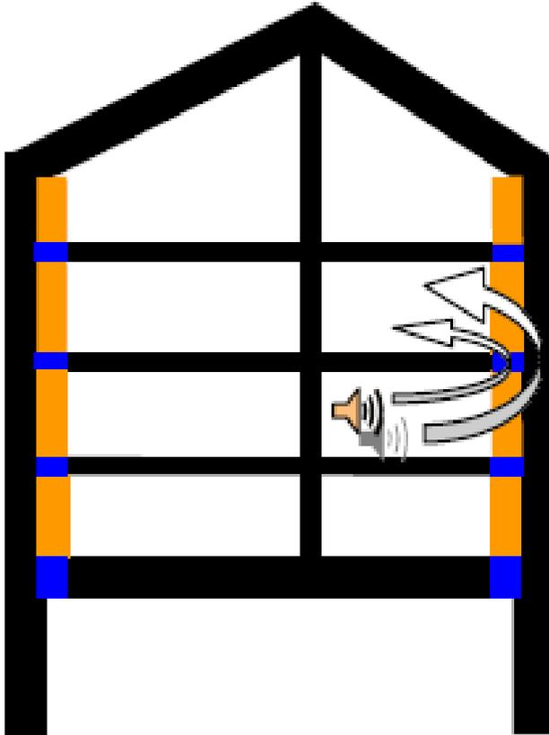
**L'isolement entre logements peut être dégradé par la pose d'un rupteur de pont thermique, deux raisons à cela :**
