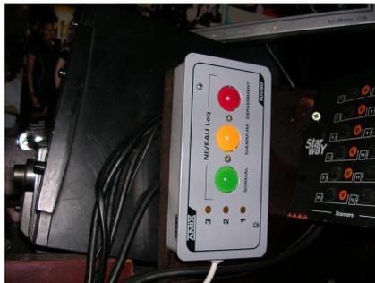
*Afficheurs d'un limiteur de pression acoustique*
