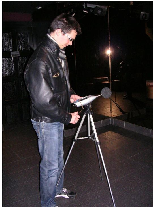
*Une mesure dans un établissement pour vérification des niveaux notamment en bandes de fréquence*
